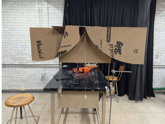
Figura 3. Se muestra el péndulo cicloidal ya armado en el laboratorio, donde se aprecian las dos varillas que los sostienen y una tercera varilla que sirvió como referencia para la altura inicial, aquí la cuerda cuelga de las guías a 167 \pm 0.1 \text{ cm} del suelo.
